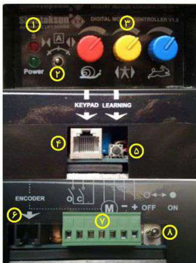
شکل شماره ۲- اجزای کنترل درب
